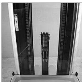
Visionmast-techniek voor sterk verbeterd zicht
