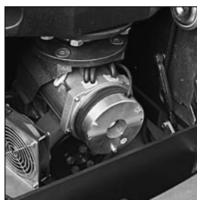
Krachtige aandrijving: electromotor op wisselstroom
