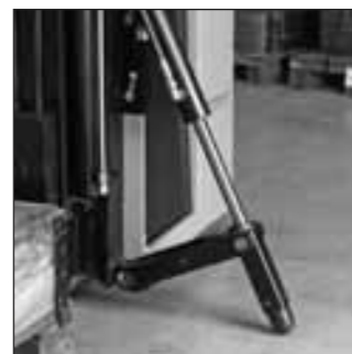
Met behulp van de als optie leverbare zijstabilisatoren kan de restcapaciteit bij grotere hefhoogtes vergroot worden (standaard op drietraps hefmast).
