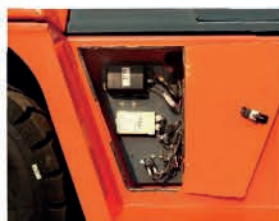
Compartimento separado para el sistema eléctrico
